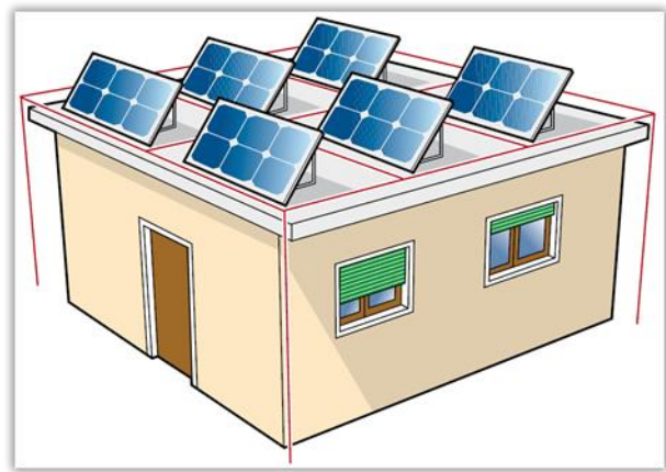
شکل ۶: تغییر طرح ساختمان به واسطه نصب سامانه برق خورشیدی و وجود سیستم حفاظت صاعقه
